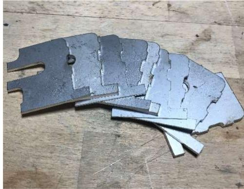
Choisir les cales à placer aux emplacement repérés (b) jusqu'à éliminer totalement le jeu (a),
