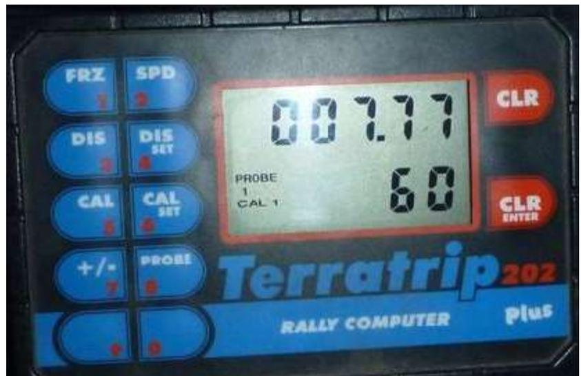
Il est préférable d'étalonner le Terratrip sur une distance plutôt qu'un calcul de circonférence qui est approximatif en raison de l'écrasement du pneu.
