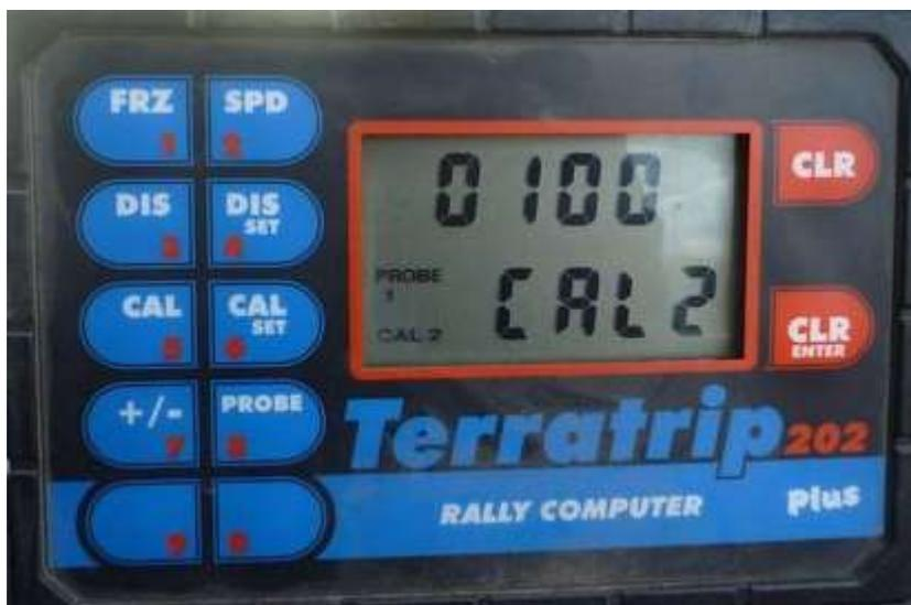
Passer en mode distance partielle en appuyant sur "DIS", puis remettre à zéro le compteur de distance partiel en appuyant le bouton "CLR ENTER". Rouler jusqu'à la prochaine borne kilométrique et arrêter la voiture au même niveau que la précédente. Puis noter le kilométrage affiché dans la fenêtre de distance partielle : 5,48
