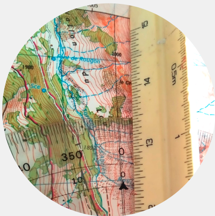
Traçage de la ligne du Nord magnétique par rapport à celle du Nord géographique (méridien) : angle de 2^{\circ} vers l'Est
